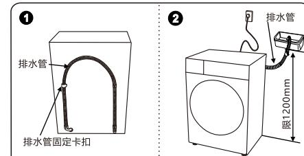
注意：图1所示排水管固定卡扣请勿下掉，排水管请勿抽离此卡扣，否则将造成洗衣故障。
