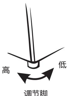
如果冰箱放置不稳定，将会产生振动和噪音，导致故障发生。另外如果安装在地毯、木地板或氯乙烯材料的地板上，冰箱散发出来的热量可能引起放置面变色，所以建议冰箱底下铺垫结实的板材。
