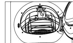
1. 打开机门后取出鞋架及挂架。
