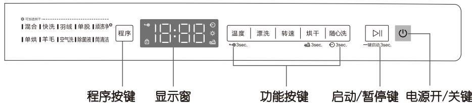
程序按键 显示窗 功能按键 启动/暂停键 电源开/关键
