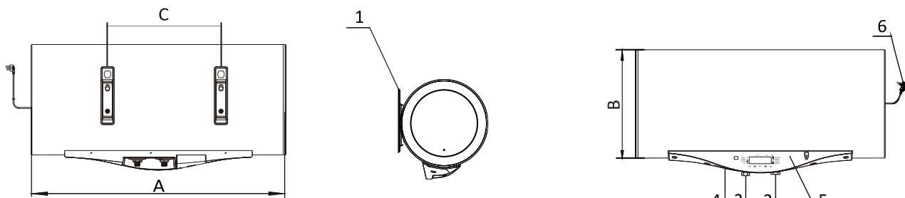
1.壁挂 2.热水出水口 3.冷水进水口 4.排污口
