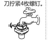
4.撕下万能接头上部的封条，旋紧万能接头。(旋紧后间隙约在2mm以下)
